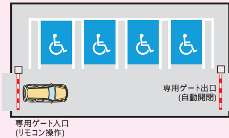
集約型専用ゲートを設置した駐車場
