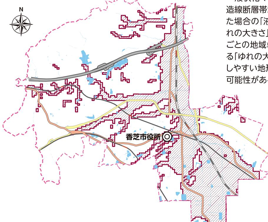
液状化マップは、「ゆれやすさマップ(中央構造線断層帯地震)」で示した強さのゆれが起こった場合の「液状化の可能性のある範囲」を、「ゆれの大きさ」と「地形」から判読し、50mメッシュごとの地域単位で示したものです。想定している「ゆれの大きさ」が大きく、低地などの液状化しやすい地形のため、平野部の多くで液状化の可能性がある結果となっています。
