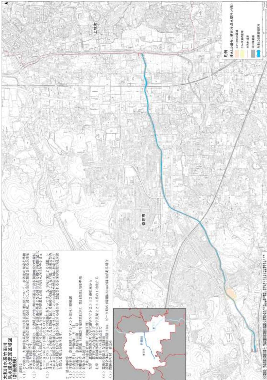
別図I-23 「大和川水系竹田川 洪水浸水想定区域図(浸水継続時間)」
