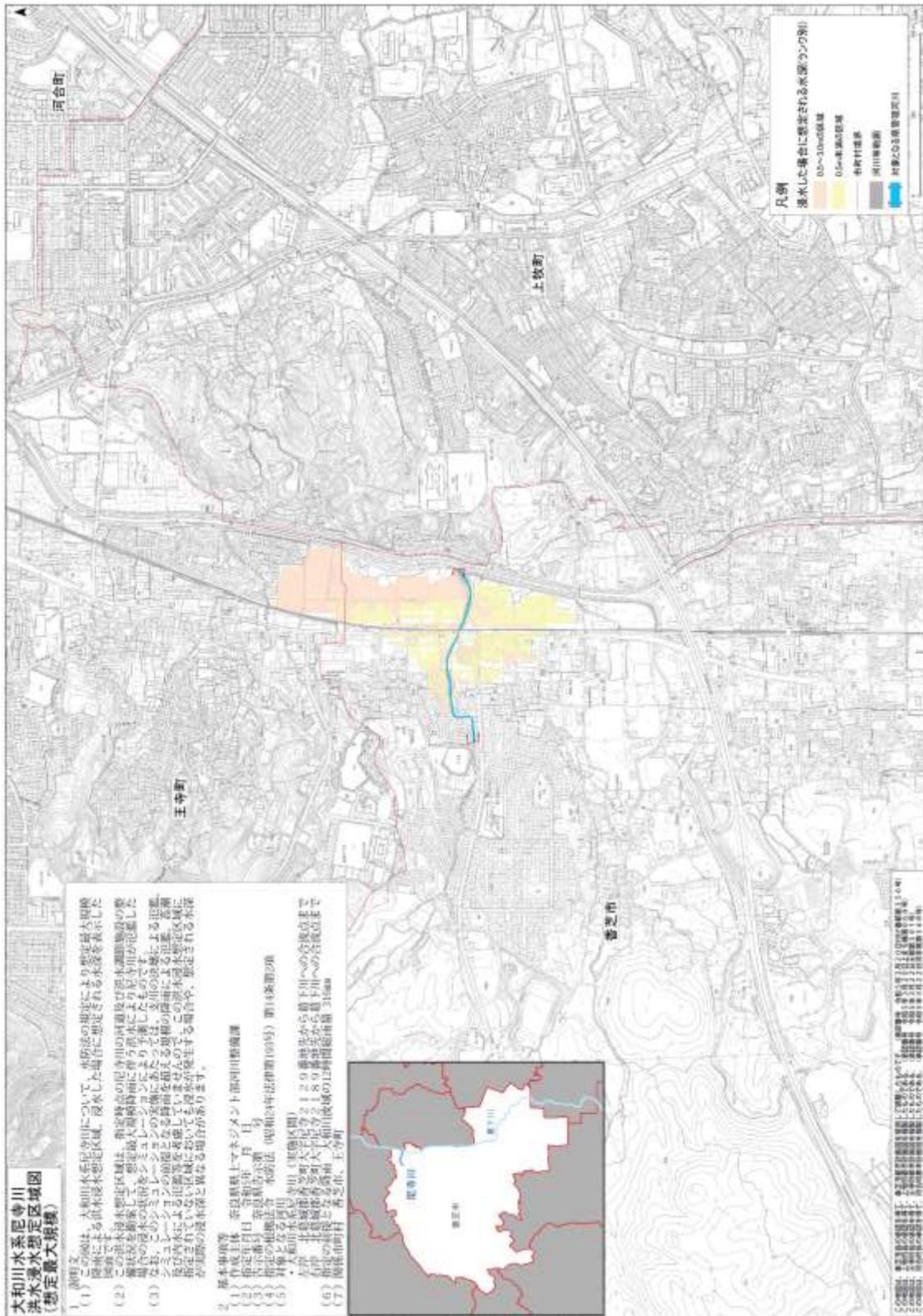
別図I-13 「大和川水系尼寺川 洪水浸水想定区域図(浸水継続時間)」
