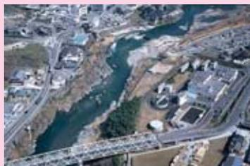
ダムを経て吉野川に流れてきた水を下市取水場へ取り込み、沈砂池でごみや砂を取り除きます。
