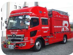
救助工作車は、火災や交通事故、自然災害など一般生活上で起きるさまざまな救助事案に必要な資機材を積載し、現場へ急行して救助活動を展開するための車です。車両にウィンチ、クレーン、照明装置、荷台にはして、油圧カッター、空気ポンプなどのたくさんの機材を搭載しています。
